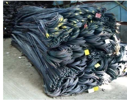
Plain Round Bar SNI 07-2052-2002 Ukuran : P.6 s/d P.32 BjTP24, BjTP30
